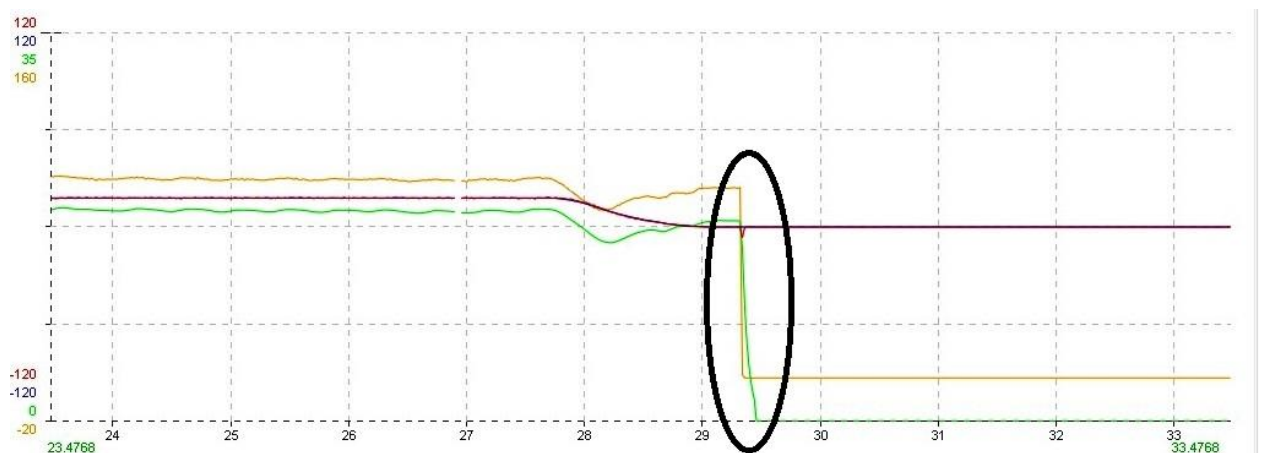
Рисунок 11.4 – Остановка синхронного двигателя с использованием функции «Ограничения момента при остановке».
